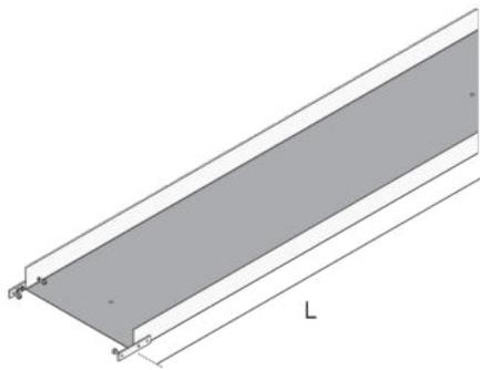
Bei den Montagekomponenten UEBSMSW handelt es sich um Bodenwannen für estrichbündige Kanalsysteme. Diese Bauteile werden aus sendzimir-feuerverzinktem Stahlblech nach DIN EN 10346 gefertigt und sind in einer Einbauhöhe von 60 bis 120 mm, einer Breite von 200 bis 500 mm, einem Nivellierbereich von 30 mm und einem Längenmaß von 2000 mm erhältlich.
