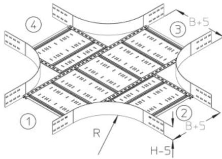
Die Weitspannkabelrinnen-Kreuzung WPRK 150 mit integrierten Verbindern dient als Formteil für sich horizontal kreuzende Weitspannkabelrinnen. Sie eignet sich für Rinnen mit einer Holmhöhe von 150 mm und weist Breiten von 200 bis 600 mm auf. Die Anschlussrinnen lassen sich mit einem Bodenverbinder VB einschieben. Verschiedene Materialien und Oberflächen sorgen dafür, dass die Korrosionsschutzanforderungen unterschiedlichster Anwendungsgebiete erfüllt werden.
