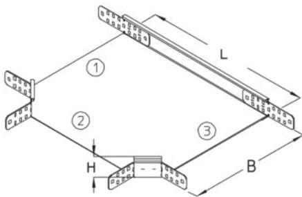
Der Kabelrinnen-Abzweig RA 35 ermöglicht horizontale Richtungsänderungen der Kabelführung in Form eines Abzweigs. Er wird zwischen zwei Kabelrinnen eingesetzt und ermöglicht den Anschluss einer weiteren Kabelrinne im rechten Winkel. Der Kabelrinnen-Abzweig eignet sich für Kabelrinnen mit Seitenhöhen von 35 mm. Verschiedene Materialien und Oberflächen sorgen dafür, dass die Korrosionsanforderungen unterschiedlichster Anwendungsgebiete erfüllt werden.
