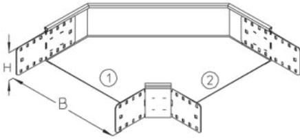
Die Kabelrinnen-Bögen RB 110 ermöglichen horizontale Richtungsänderungen der Kabelführung um 90°. Sie eignen sich für Kabelrinnen mit Seitenhöhen von 110 mm und verfügen über integrierte Seitenverbinder. Mithilfe eines Bodenverbinders VB wird der Bogen in die Kabelrinne eingeschoben und verschraubt. Verschiedene Materialien und Oberflächen sorgen dafür, dass die Korrosionsanforderungen unterschiedlichster Anwendungsgebiete erfüllt werden.
