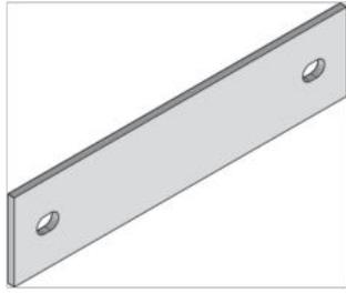
Bei den Bauteilen UBKPRV handelt es sich um Verbinder für estrichbündige Schwerlastkanäle. Sie werden dazu verwendet, die Seitenprofile an den Stoßstellen miteinander zu verschrauben. Die Artikel sind aus sendzimir-feuerverzinktem Stahlblech gemäß DIN EN 10346 gefertigt und in einer Länge von 150 mm, einer Höhe von 35 mm, einer Materialstärke von 3 mm erhältlich.
