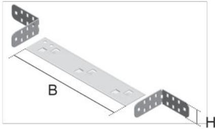
Bei der Produktlösung UKAZ handelt es sich um Anbauzubehör für estrichüberdeckte Kanalsysteme. Mithilfe der Zubehörelemente werden die Kanalsegmente verbunden und auf diese Weise Formteile erstellt. Die Zubehörteile sind aus sendzimir-feuerverzinktem Stahlblech nach DIN EN 10346 gefertigt.
