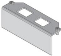
Bei den Bauelementen UEP125 KS handelt es sich um Einbauplatten aus dem Produktsortiment der Unterflursysteme. Diese Zubehörteile können mit zwei angeschlossenen Keystone-Datenjacks bestückt und anschließend seitlich mit dem Rahmen eines Kompakteinzelauslasses verschraubt werden. Die Platinen sind aus sendzimir-feuerverzinktem Stahlblech nach DIN EN 10346 gefertigt.
