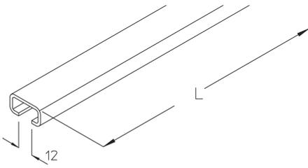
Die Profilschiene B 6 ist ungelocht und besteht aus einem C-Profil 28 x 15 mm mit einer Schlitzweite von 12 mm (Materialstärke = 2,3 mm). Verschiedene Materialien und Oberflächen sorgen dafür, dass die Korrosionsanforderungen unterschiedlichster Anwendungsgebiete erfüllt werden. Sie ist in den Längen 3000 oder 6000 mm lieferbar.
