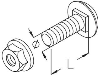
Das Klemmbefestigungsset KLS dient zur Befestigung unserer Kabelleitern und Weitspannbahnen, aber auch zur Befestigung von Gitterbahnen an Deckenbügeln oder der Montage von Konsolen an Konsolträgern. Verschiedene Materialien und Oberflächen sorgen dafür, dass die Korrosionsschutzerfordernisse unterschiedlichster Anwendungsgebiete erfüllt werden.
