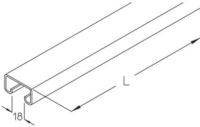
Die Profilschiene A 8 ist ungelocht und besteht aus einem C+-Profil 40 x 22 mm mit einer Schlitzweite von 18 mm (Materialstärke = 2 mm). Verschiedene Materialien und Oberflächen sorgen dafür, dass die Korrosionsanforderungen unterschiedlichster Anwendungsgebiete erfüllt werden. Sie ist in den Längen 3000 oder 6000 mm lieferbar.
