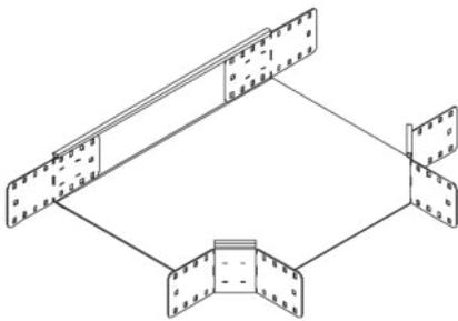
Der Kabelrinnen-Abzweig RA 110 ermöglicht horizontale Richtungsänderungen der Kabelführung in Form eines Abzweigs. Er wird zwischen zwei Kabelrinnen eingesetzt und ermöglicht den Anschluss einer weiteren Kabelrinne im rechten Winkel. Der Kabelrinnen-Abzweig eignet sich für Kabelrinnen mit Seitenhöhen von 110 mm. Verschiedene Materialien und Oberflächen sorgen dafür, dass die Korrosionsanforderungen unterschiedlichster Anwendungsgebiete erfüllt werden.
