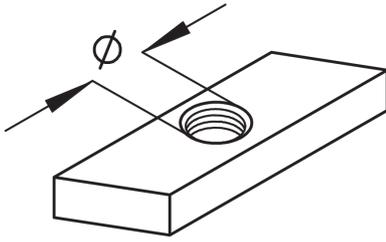
Ankermuttern AM 16 sind Gewindeplatten, die bei Profilschienen B 7 eingesetzt werden. Durch eine 90°-Drehung nach dem Einlegen oder Einkippen steht die Gewindebohrung mittig. Die auch als Gleitmuttern bezeichneten Ankermuttern werden vorzugsweise zur Abstandsmontage mit langen Schrauben oder Gewindestäben verwendet. Sie bestehen aus tauchfeuerverzinktem Stahl mit Gewinden M6 oder M8 sowie aus Edelstahl mit Gewinde M6.
