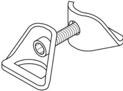
Das Spannschloss SC dient in Zusammenhang mit der Grundplatte GP und dem SD Spannband dazu, einen Befestigungspunkt mit Gewinde M8 an einer Konstruktion herzustellen. Das Spannschloss besteht aus tauchfeuerverzinktem Stahl.
