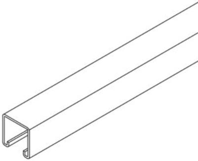
Die Profilschiene A 41 ist ungelocht und besteht aus einem C+-Profil 41 x 41 mm mit einer Schlitzweite von 22 mm (Materialstärke = 2,5 mm). Verschiedene Materialien und Oberflächen sorgen dafür, dass die Korrosionsanforderungen unterschiedlichster Anwendungsgebiete erfüllt werden. Sie ist in den Längen 3000 oder 6000 mm lieferbar.
