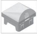
Bei dem Bauelement UAPAM45 handelt es sich um 1-fache Kabelausslässe aus dem Sortiment der Installationsgeräte für Unterflursysteme. Diese Auslässe können in Installationsöffnungen mit den Maßen 45x45 mm eingerastet werden. Sie dienen als stabile Zugentlastung für Kabel mit einem maximalen Durchmesser von 6mm. Die UAPAM45 sind aus hochwertigem Polycarbonat in der Farbe Weiß gefertigt.
