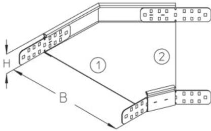
Die Kabelrinnen-Bögen RB45 110 ermöglichen horizontale Richtungsänderungen der Kabelführung um 45°. Sie eignen sich für Kabelrinnen mit Seitenhöhen von 110 mm und verfügen über integrierte Seitenverbinder. Mithilfe eines Bodenverbinders VB wird der Bogen in die Kabelrinne eingeschoben und verschraubt. Verschiedene Materialien und Oberflächen sorgen dafür, dass die Korrosionsanforderungen unterschiedlichster Anwendungsgebiete erfüllt werden.
