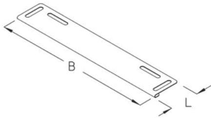
Das Kabelrinnen-Endblech REB wird im Falle offener Kabelrinnen-Enden in den Boden der Kabelrinne eingeschoben und verschraubt und dient dem Schutz der ein- oder ausführenden Leitungen. Es eignet sich jedoch auch als Zwischenstück bei horizontaler oder vertikaler Richtungsänderung gemäß Montageanleitung. Verschiedene Materialien und Oberflächen sorgen dafür, dass die Korrosionsanforderungen unterschiedlichster Anwendungsgebiete erfüllt werden.
