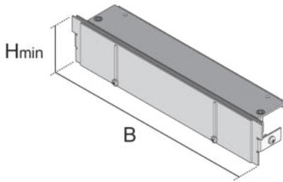
Bei den Bauelementen UEBSES handelt es sich um Endstücke, die dem Verschließen estrichbündiger Kanäle dienen. Die Produktlösungen sind an eine Bodenbelagshöhe von 3 mm anpassbar. Sie werden aus sendzimir-feuerverzinktem Stahlblech nach DIN EN 10346 gefertigt und in einer minimalen Einbauhöhe von 60 oder 100 mm, einem Nivellierbereich von 50 mm, einer Breite von 200 bis 500 mm und inklusive einer Traverse geliefert.
