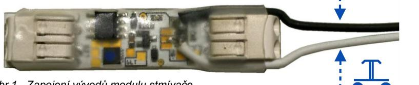
Obr. 1 - Zapojení vývodů modulu stmívače
